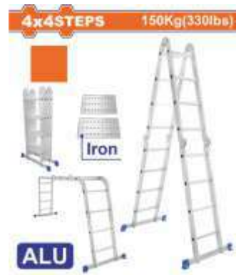
WLD7H44 Πολυμορφική σκάλα αλουμινίου 4 x 4 σκαλοπάτια Υλικό: αλουμίνιο Ύψος σκαλοπατιού: 27cm Μήκος: 337cm Ύψος σκάλας: 217cm Ύψος σκαλωσιάς: 121cm Αντοχή: 150 kg / Βάρος : 11.6 kg
