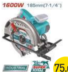
TS1161856 Επαγγελματικό δισκοπρίνο χειρός ξύλου 1600W / Στροφές 5000rpm Βάθος κοπής 90° 65mm / 45° 44mm Δίσκος Φ-185mmX20mm Βάρος 5.0 kg
