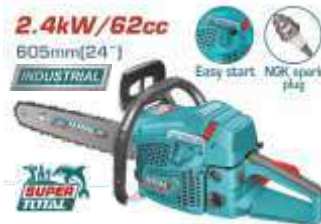
TG5602411 Αλυσοπρίονο βενζινοκίνητο επαγγελματικό Κινητήρας 2ΧΡΟΝΟΣ 62cc / 3.2HP / 3100rpm Λάμα 60cm/24" Βάρος 8.5Kg
