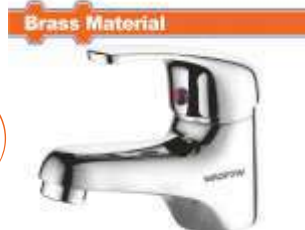
WZD1501 Μπαταρία νιπτήρος Σώμα από ορείχαλκο + λαβή ψευδαργύρου Κεραμικό d=35mm Με 2 εύκαμπτους σωλήνες από ανοξείδωτο χάλυβα Βρύση ζεστού και κρύου νερού Βάρος : 650 gr
