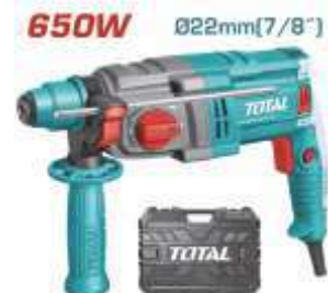
TH306236 Πιστολέτο περιστροφικό σκαπτικό SDS-PLUS 650W / 1.7J / Στροφές 0-1700rpm Κρούσεις 0-5500bpm Διάτρηση 22mm (μπετόν)
