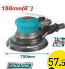
TAT91512 Επαγγελματικό έκκεντρο τριβείο αέρος Φ-150mm / 6.2bar 10500rpm Σωλήνα παροχής 3/8" Βάρος 1.65kg
