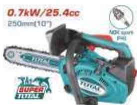
TG5261011 Αλυσοπρίονο βενζινοκίνητο κλαδευτικό Κινητήρας 2ΧΡΟΝΟΣ 25.4cc / 1HP / 3300rpm Μήκος λάμας 25cm/10" Αλυσίδα 3/8" - 1.3mm Βάρος 3Kg
