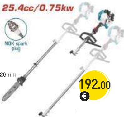
TG5261012 Αλυσοπρίονο επαγγελματικό βενζινοκίνητο κλαδευτικό με carving λάμα Κινητήρας 2ΧΡΟΝΟΣ 25.4cc / 1HP / 3300rpm Μήκος λάμας 25cm/10" Αλυσίδα 1/4" - 1.1mm Βάρος 3Kg
