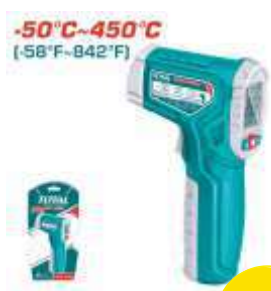
THIT0155028 €13.00 Ψηφιακό θερμόμετρο -50°C έως 450°C (-58°F έως 842°F) Χρόνος απόκρισης <0.5S Αυτόματη απενεργοποίηση Ακατάλληλο για άνθρωπο Βάρος 175gr
