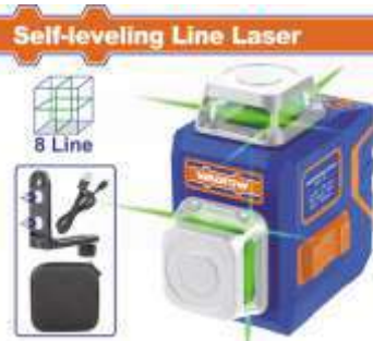
WLE1M08 Αλφάδι LASER αυτο-οριζοντιούμενο 0-30m 8 LINE με πράσινες ακτίνες Ένα οριζόντιο επίπεδο 360° και ένα κάθετο επίπεδο 360° Ακρίβεια: ±3,0mm στα 10m Ακρίβεια γραμμής: ±1,5mm / 5m Ενσωματωμένη μπαταρία λιθίου Με λειτουργία cross lock
